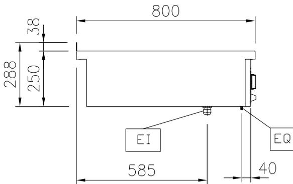
EI = Conexión eléctrica (energía)
